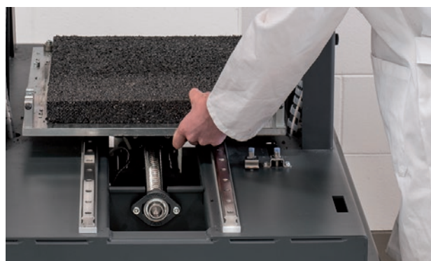
Sistema con placa de 500 x 400 mm y husillo a bolas de precisión
