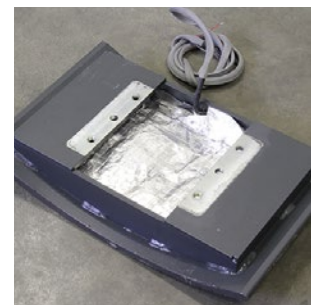
Sistema de calentamiento incorporado en el soporte de la base del molde.
