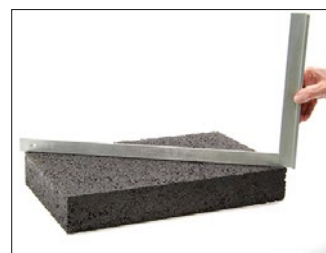
Muestra compactada optimamente que garantiza una planeidad regular y homogénea (moldes PRO)
