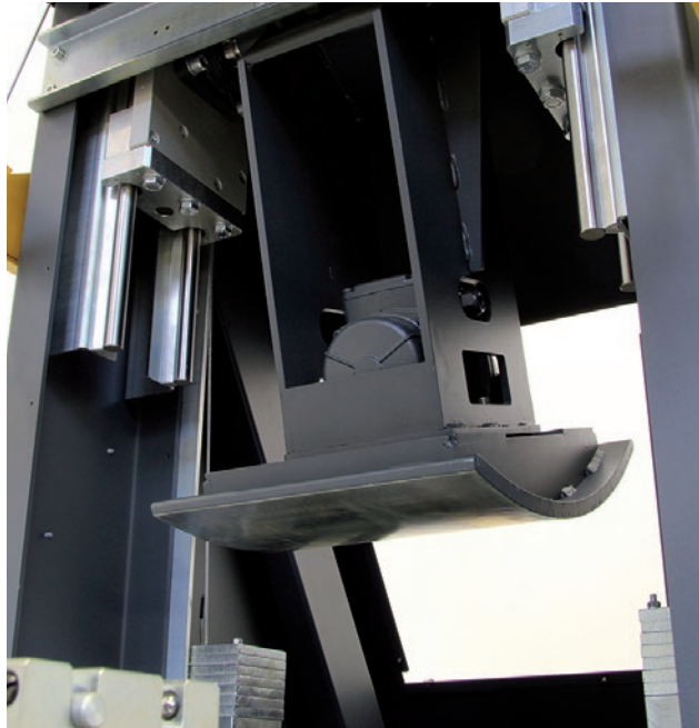
Detalle del rodillo con Sistema de vibración
