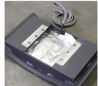
Sistema de calentamiento incorporado en el soporte de la base del molde.
