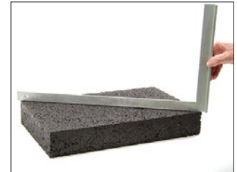
Muestra compactada optimamente que garantiza una planeidad regular y homogénea (moldes PRO)
